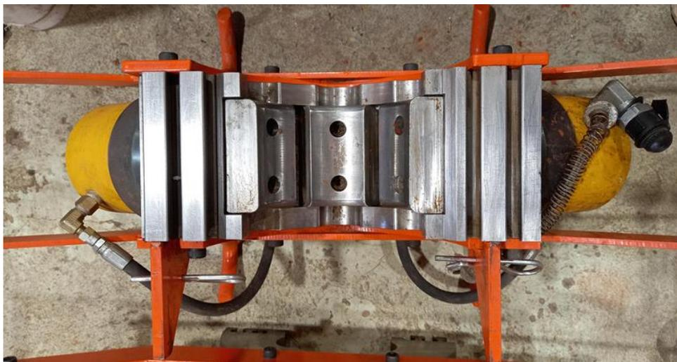
**Fig. 24** – Detalle de las mordazas de la prensa.
