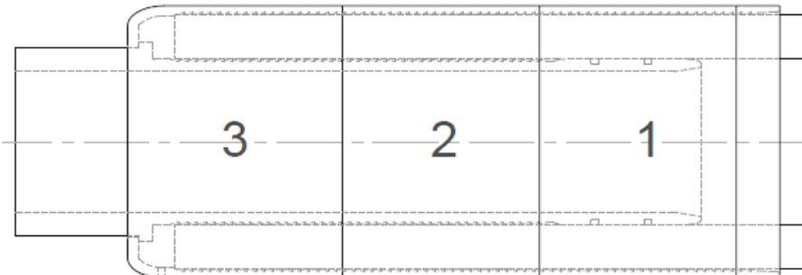
**Fig. 26** – Las 3 posiciones de prensado en el conector.
