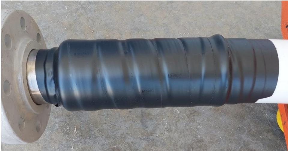
**Fig. 29** –cinta STOPAQ de protección mecánica.
