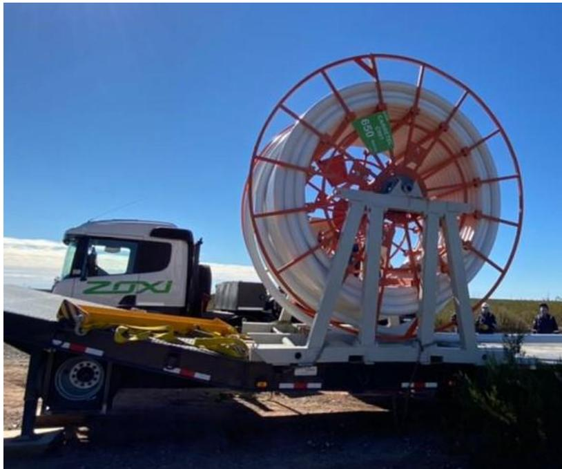
**Fig. 11** – Carretel montado en el camión sobre la estructura “porta carretel”.
