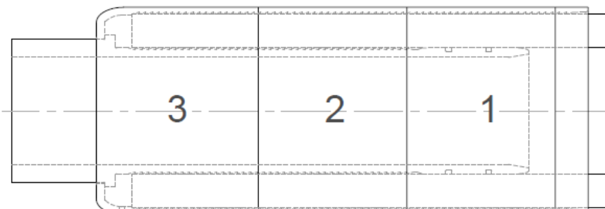
Fig. 26 – Las 3 posiciones de prensado en el conector.
