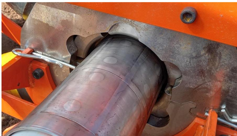
**Fig. 25** – Prensadora con mordazas abiertas.
