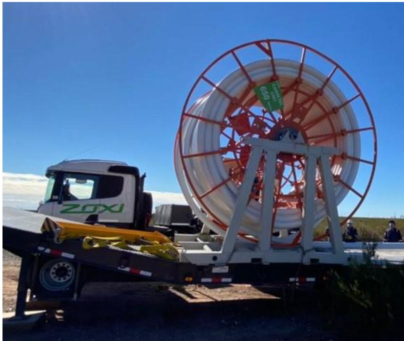
Fig. 11 – Carretel montado en el camión sobre la estructura “porta carretel”.
