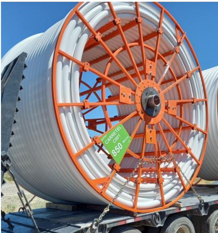
Fig. 12 – Carretel asegurado a la estructura del camión listo para transportar.
