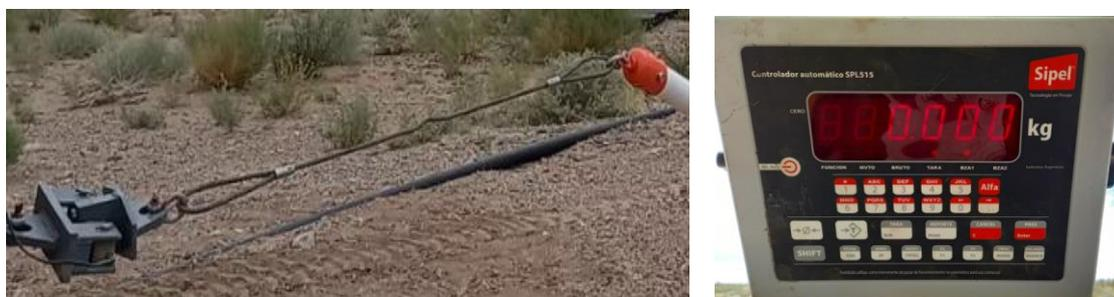
Fig. 15 – Celda de carga de tracción y display.
